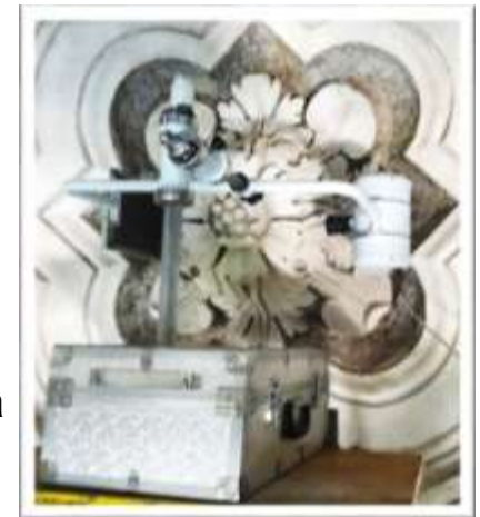
Strumentazione per radiografia portatile presente presso i laboratorio dell'ICLA
